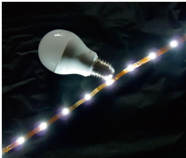
Figuur 1 Twee voorbeelden van moderne verlichting gebaseerd op blauwe leds. De rij leds die aan is bestaat uit blauwe leds met een laag die de kleur omzet in zichtbaar licht. De traditioneel uitzijende lamp bestaat in werkelijkheid ook uit blauwe leds en werkt op dezelfde manier.
